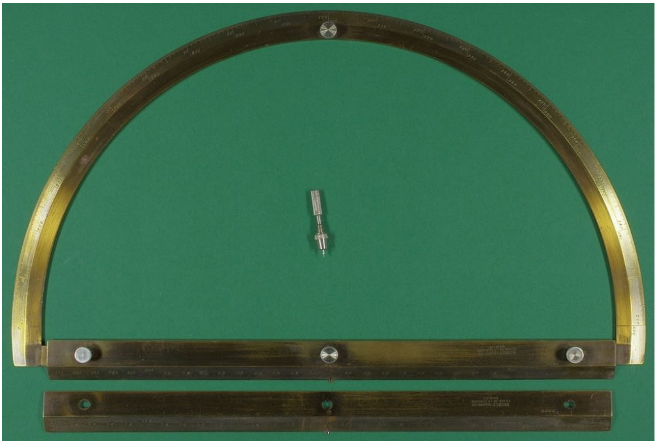
Rapporteur tachéométrique RICHER-LEJARD de 35 cm en laiton, gradué en grades, avec deux réglottes interchangeables et piqueur-centreur.
